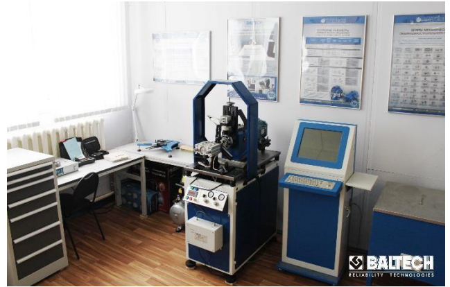
Стенд контроля качества подшипников ПРОТОН-СПП-II
